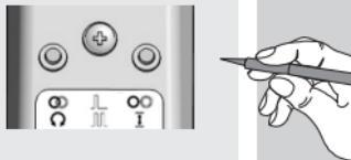
Relâcher la touche « Rupture » dès que la DEL de contrôle reste en permanence allumée en orange.
